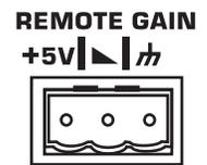
Se ha proporcionado un conector de tipo europeo de 3 patillas (Figura 34) para ajustar el volumen del altavoz serie KLA o para colocar el sistema en espera.
