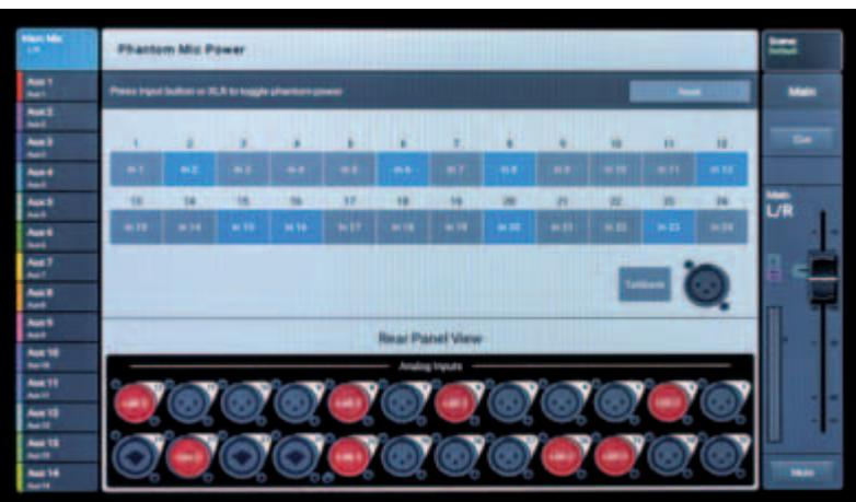
Sehr gut gelöst: Die Phantomspeise-Steuerung mit rot markierten Eingängen
