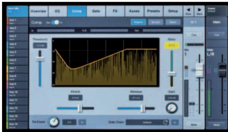
Darstellung des Kompressor-Regelverhaltens mit allen verfügbaren Einstellparametern und Pegelinstrumenten
