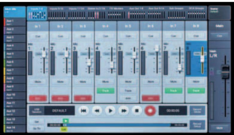
Die Inputs 1 bis 8 mit Spurenscharfschaltung und Laufwerksteuerung
